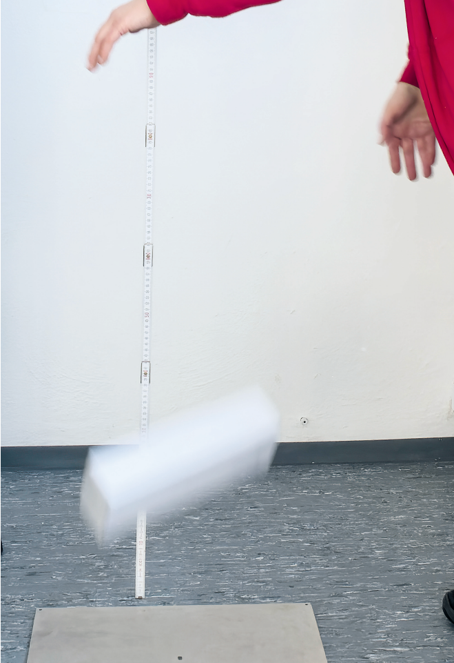
Harte Bandagen: Beim Falltest wird eine neue Verpackung aus 80 Zentimetern Höhe auf eine Stahlplatte fallen gelassen.
