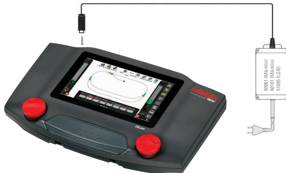
Raccordement Alimentation électrique Central Station
