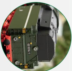
Mit Einheitsender 227134 umgebaut auf Ölfeuerung. With a type 227134 standard design tender converted to oil firing.
