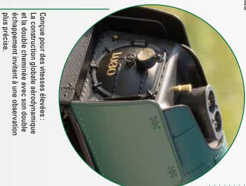
Conçue pour des vitesses élevées, la construction globale aérodynamique et la double cheminée avec son double échappement invitent à une observation plus précise.
